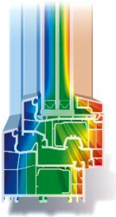
Dreidimensionale Darstellung zur Veranschaulichung von Isothermenverläufen (Isothermen: Linien gleicher Temperatur) in einem Fensterquerschnitt
